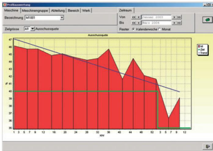
Bild 3: Kontinuierliche Verfolgung der Auswirkung von KVP-Maßnahmen in Echtzeit am Beispiel einer Ausschussentwicklung.
