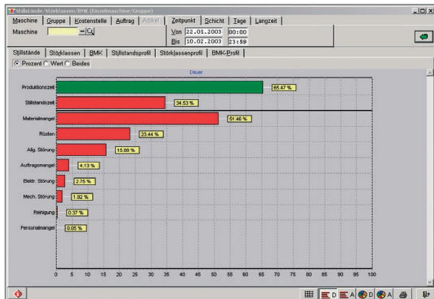
Bild 2: Beispiel einer Stillstandsanalyse. Durch die Vorgaben werden die Mitarbeiter angeleitet, eigene und unter Umständen neue Wege zu finden, um die Ziele zu erreichen. Die Mitarbeiter haben mit Hydra jederzeit Zugriff auf die aktuellen Kennzahlen.
