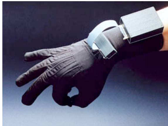
Abbildung 7: Datenhelm zur stereografischen Visualisierung virtueller Welten und Datenhandschuh zur Erfassung von Lage und Ausrichtung der Hand und der Finger [5dt01].
