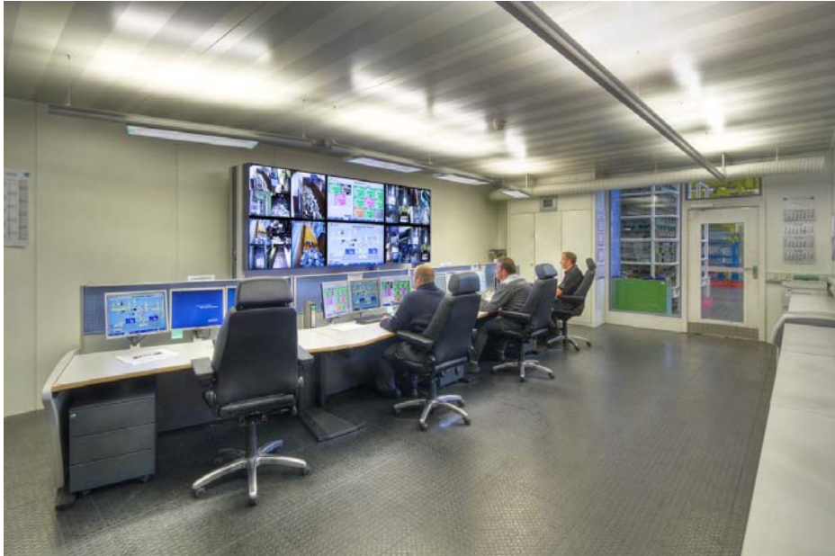
Bild 5: Leitwarte in einem Presswerk – Systemübergreifende Visualisierung des kompletten Produktionsprozesses
