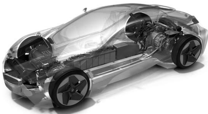
BMW Vision EfficientDynamics: Zentrale Elemente des Antriebskonzeptes
