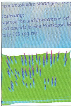
Abb. 3: Braillepunkte auf einer Faltschachtel (oben) und deren dreidimensionale Darstellung (unten)
