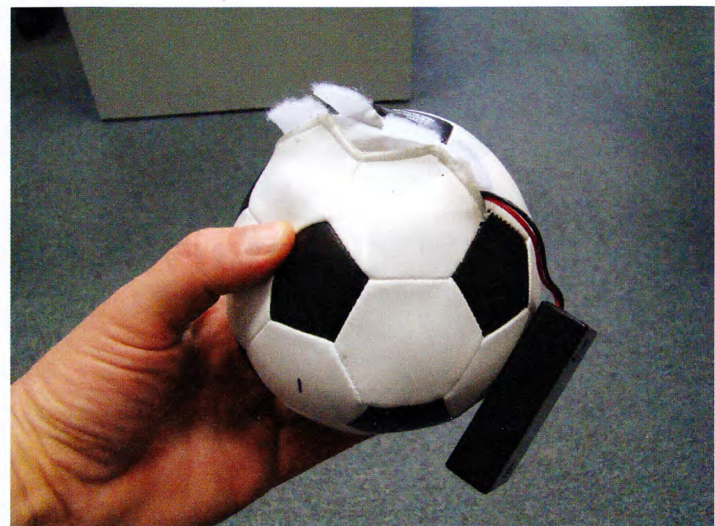
DRB-Abhörschutzteam, „Non-linear Junction Detector“, Suche nach Halbleitern Wanze in Spielball getarnt
