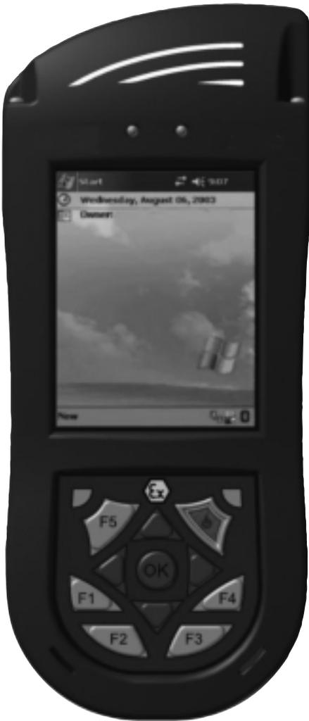
**Ein PDA mit integriertem RFID-Reader ist der Branche kein Novum mehr. Dieses Gerät kann allerdings auch in explosionsgefährdeten Räumen eingesetzt werden.**
